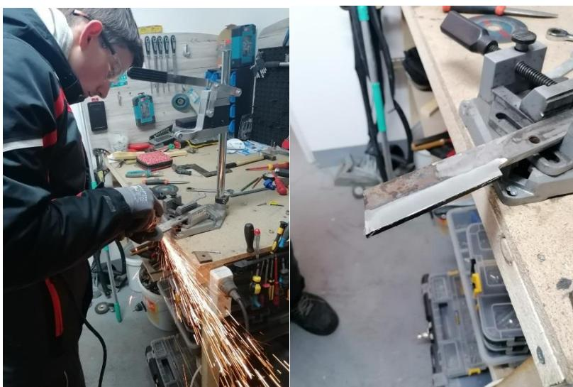
Potem sem na brusilki zamenjal nastavek za fino brušenje oziroma poliranje in z tem nožu
